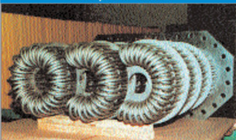
Трубная система эжектора. Материал: титан
