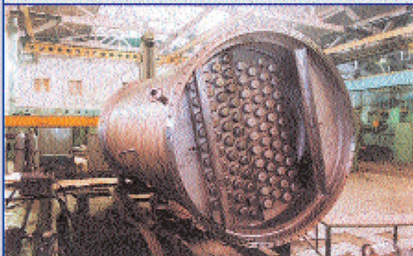
Секция ректификационной колонны с колпачковой тарелкой
