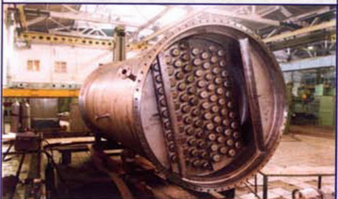
Секция ректификационной колонны с колпачковой тарелкой
